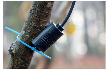
Abbildung 3: Der Sensor zur Messung der Lufttemperatur und -feuchtigkeit wird in 2 m Höhe auf der Nordseite des Baumes angebracht. © Daria Göllnitz / GLOBE Schweiz
